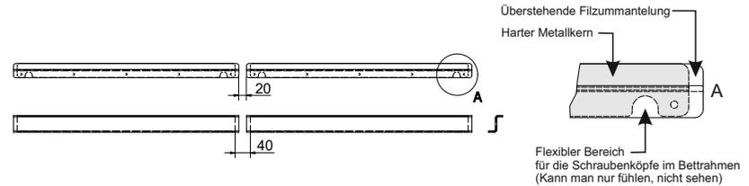
Beim Modell VW T6.1 befinden sich Schraubenköpfe links und rechts am Lattenrost (B). Die Leisten (A) sind an dieser Stelle flexibel gefertigt, so dass der Höhenunterschied der Schraubenköpfe ausgeglichen wird.
